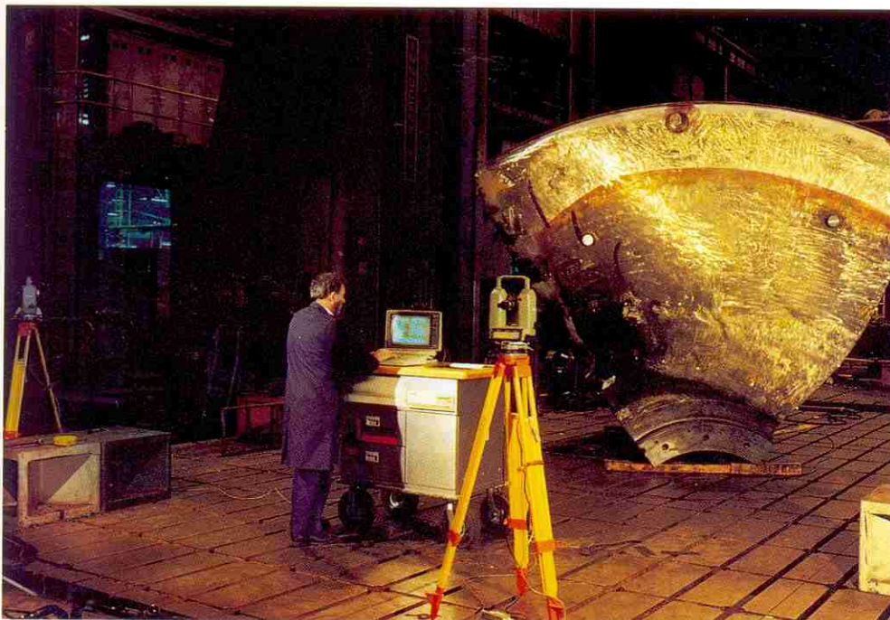
9. Contrôle de la géométrie de la roue au moyen d'un système optique composé de 2 théodolites numériques reliés à un ordinateur. On remarque la partie rechargée en acier inoxydable à la périphérie de la roue (photo GE Canada-AID).
