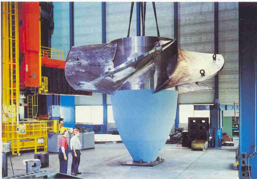
2. Roue à aubes fixes, avant soudure des lèvres anticavitation (photo Sulzer-Escher Wyss).
