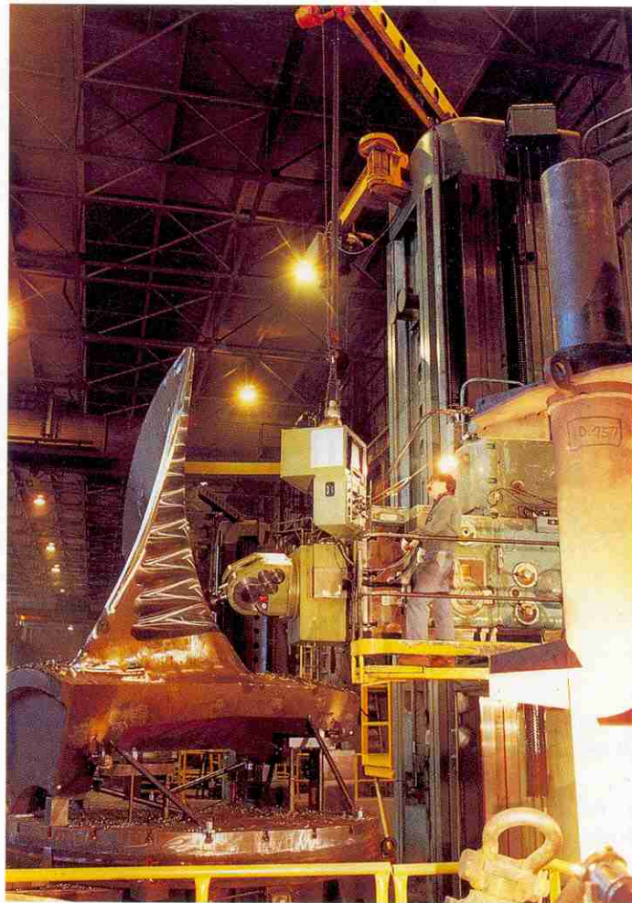
8. Usinage des aubes sur une machine à commande numérique à 5 axes (photo GE Canada-AID).
