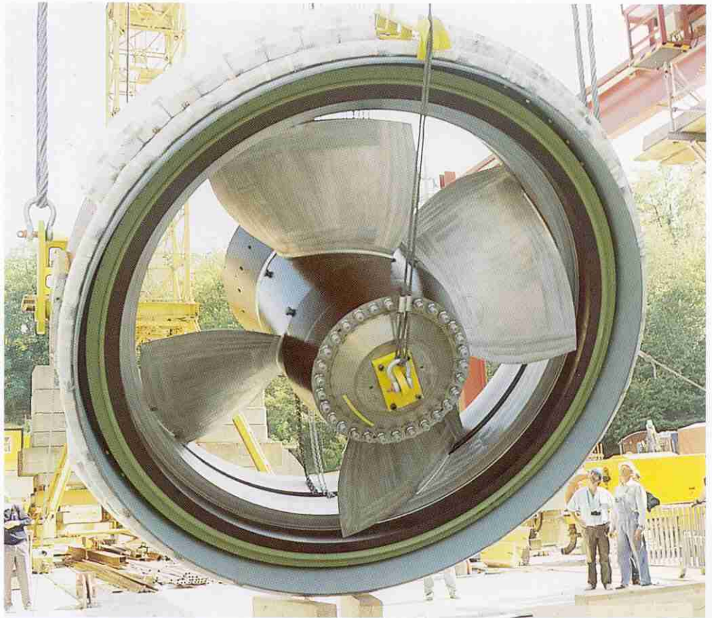
9. Roue et rotor de l'alternateur prêts à être montés dans la machine (photo Sulzer-Escher Wyss).
