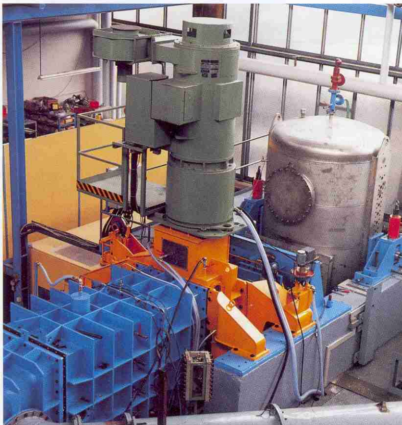
5. Essai d'un bulbe sur la plate-forme d'essai du laboratoire Aströ (photo Aströ).
