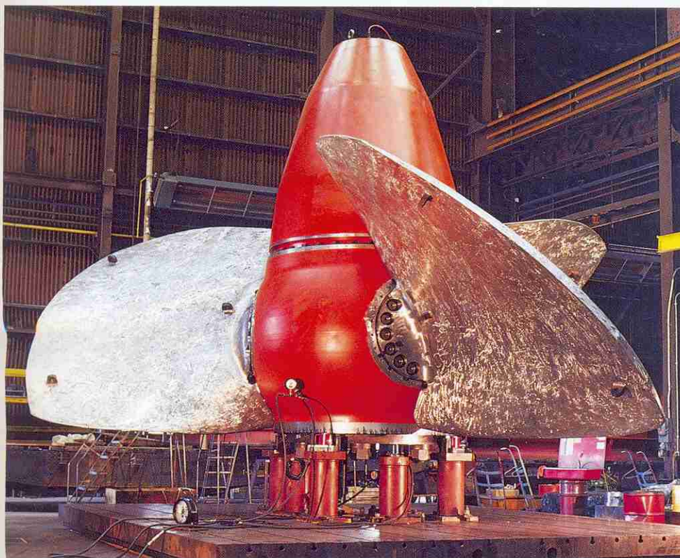
2. Roue au cours de l'essai du mécanisme de commande des pales en ateliers (photo Voith).
