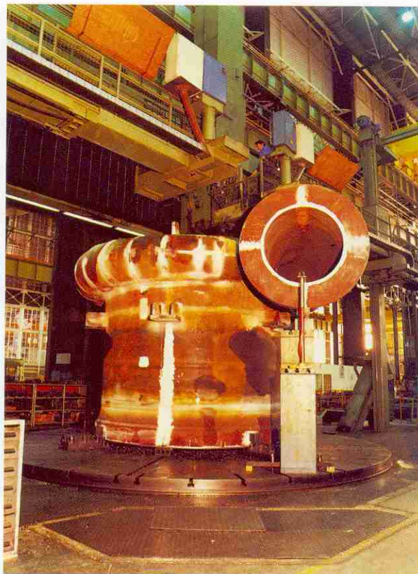
6. Bâche spirale, avant-distributeur et corps de pompe en cours d'usinage (masse totale 115 t) (photo Neyrpic).
