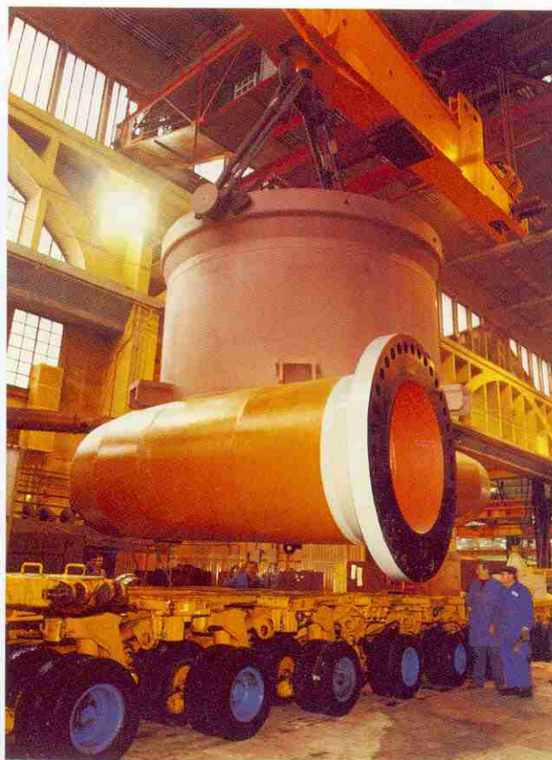
7. Ensemble, bâche spirale avant-distributeur, corps de pompe, prêt pour le transport sur le chantier (photo Neyrpic).
