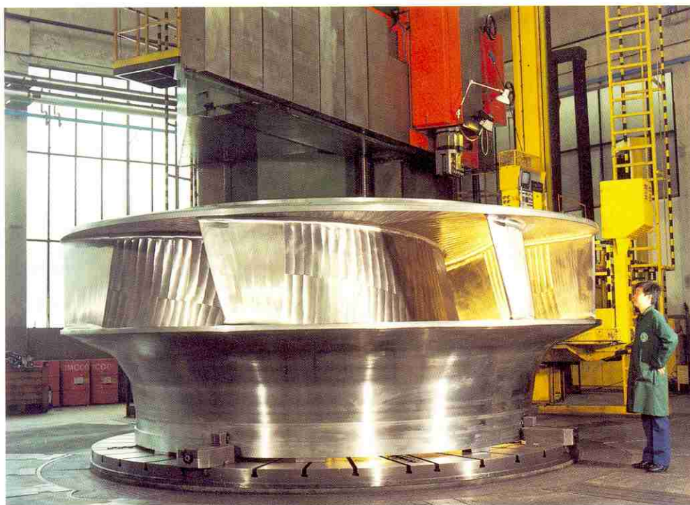
6. Roue de la pompe-turbine en cours d'usinage final (photo De Pretto-Escher Wyss).
