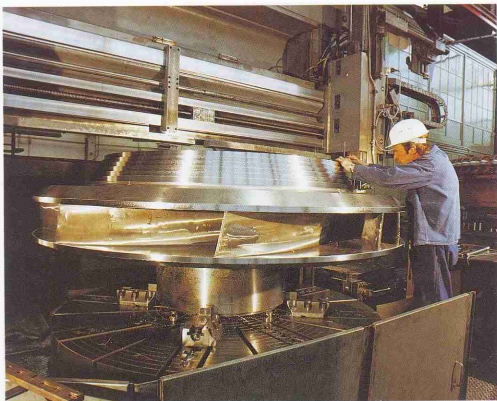
4. Roue de la pompe en cours d'usinage. Diamètre 7,724 m, masse 9 t (photo Voith).
