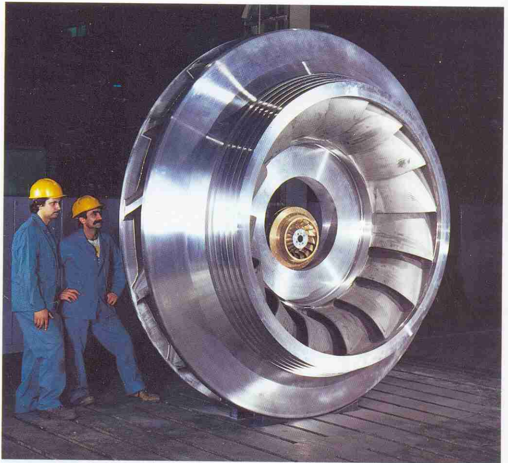
9. Roue prototype ( D_{1i} = 2,767 m) et roue modèle ( D_{1i} = 0,472 m) (photo Sulzer-Escher Wyss).
