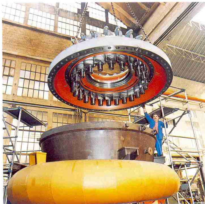
6. Distributeur aval (2 e étage en turbine) la pièce est retournée par rapport à sa position réelle (photo Neyrpic).
