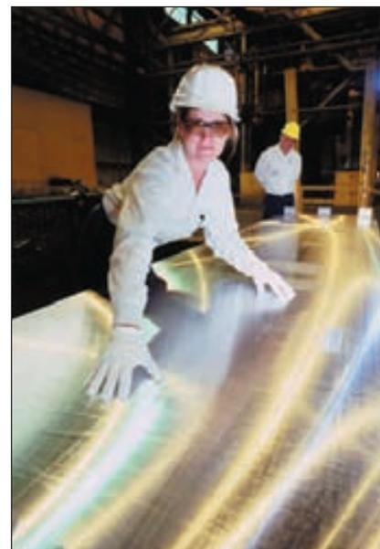
Láminas de aluminio son inspeccionadas bajo las lámparas de control de calidad en la línea de producción de aluminio de la planta de extrusión Alcoa Székesfehérvár, en Hungría.
