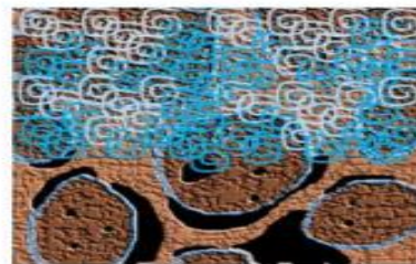
El solvente reduce su viscosidad y desplaza el petróleo
