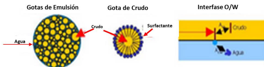
Figura 5. Función de los productos químicos en el transporte de crudos.
