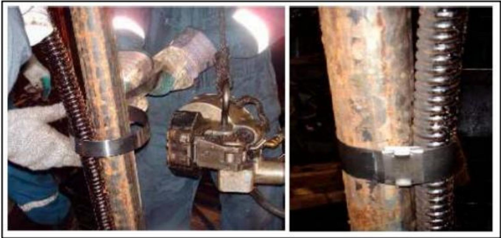
**Bandas para la fijación del cable a la tubería de producción**
