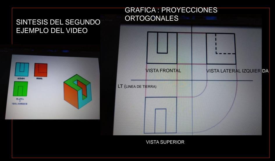
EN SINTESIS: La intersección de los planos horizontal y vertical es la "LT" Las VISTAS se relacionan unas con otras a traves de rectas verticales y horizontales perpendiculares y paralelas a la LT ( línea de Tierra)
