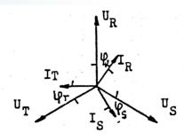
El vatímetro 1 indicará: $P_R = U_R.I_R.cos\varphi_R = \overline{U_R}.\overline{I_R}$
