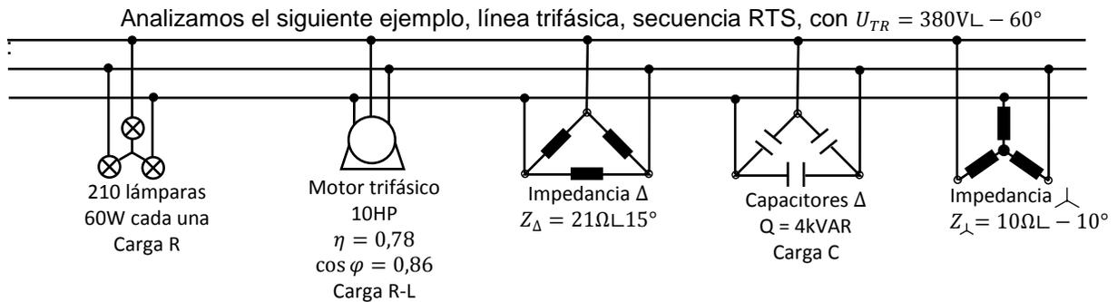
Si resolvemos uno por uno estos sistemas trifásicos, podríamos obtener cada una de las corrientes. Para ello, reducimos cada sistema a estrella, transformando los triángulos en estrella, y trabajamos como si estuviéramos en un sistema monofásico. Entonces:
