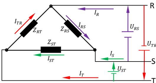
Tenemos ahora impedancias conectadas en triángulo, como se muestra en la figura. Entonces por la regla de las mallas tenemos que:
