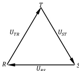
4°- Si se trata de cargas equilibradas, estableceremos entre cada vértice y el centro del triángulo, las tensiones de fase, quedándonos armado el triángulo didáctico, donde rápidamente podemos ubicar los vectores y sus ángulos.
