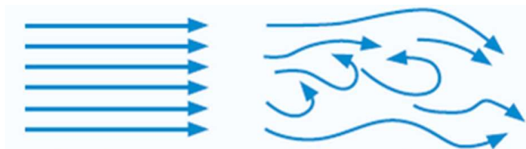
Figura 2.6 Movimiento laminar (izquierda) – Movimiento turbulento (derecha)
