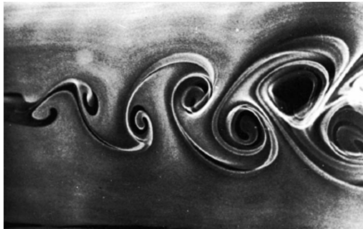
Figura 3.29. Desprendimiento de torbellinos de un cilindro circular sumergido en una corriente estacionaria. (White, 2004, pág. 305)
