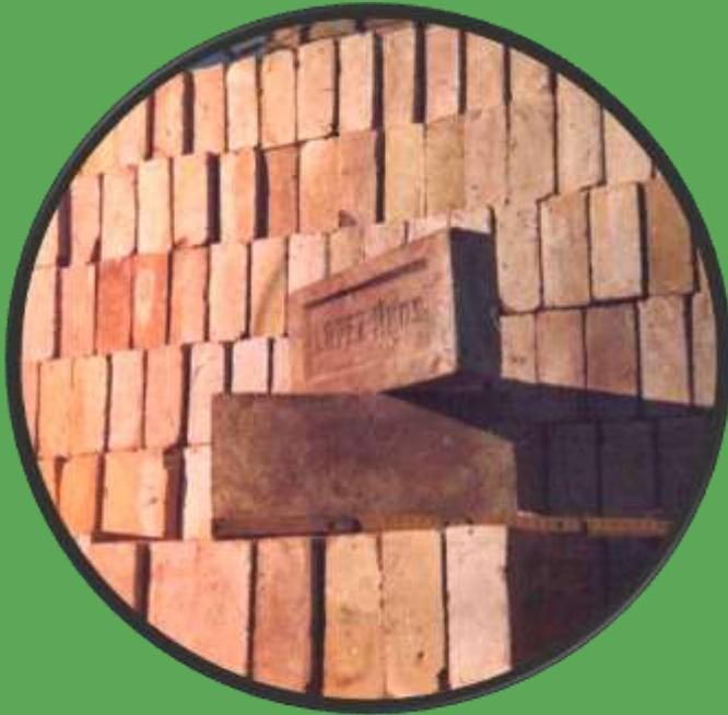
Es el conjunto constituido por **mampuestos** (ladrillos que pueden ser manipulados por un solo operario y puestos con la mano) unidos por un **mortero** (mezcla plástica de un aglomerante, áridos y agua) que se comporta como un elemento de construcción **unitario continuo**, usado para ejecutar muros y tabiques.
