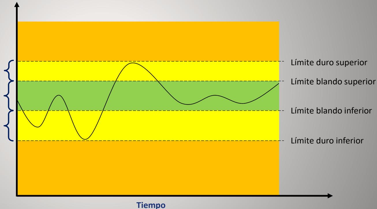
Por encima del límite duro superior y por debajo del límite duro inferior el controlador toma una acción más agresiva sobre la variable controlada
