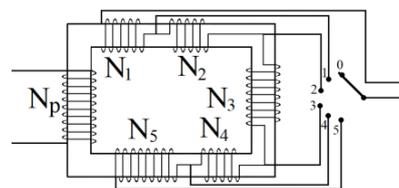
Si se lo conecta a una fuente  $\sim$  de 220 V y se desea obtener 2,0 V; 5,0 V; 10 V; 13; y 20 V, ¿cuántas vueltas  $N_i$  debe tener cada uno de los bobinados?
