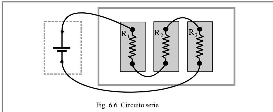
Interconectar los tres resistores del panel conforme a lo representado en el diagrama circuital. Medir  $R_{eq}$  con el tester. Verificar la regla. Registrar cálculos.
