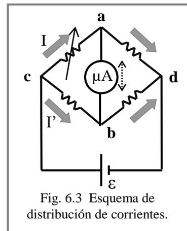
Fig. 6.3 Esquema de distribución de corrientes.
