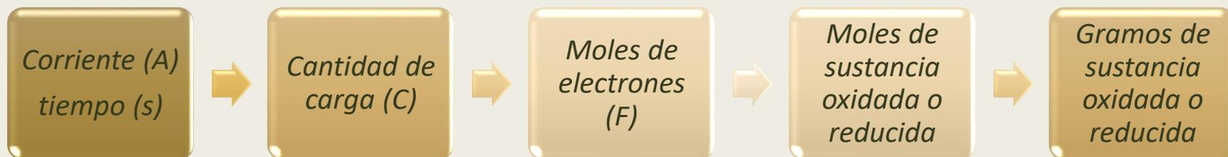
**EJEMPLO 7.** Determine cuántas horas se requieren para depositar 25 g de cobre metálico a partir de  $\text{CuSO}_4(\text{ac})$  1 M utilizando una corriente de 3 A.
