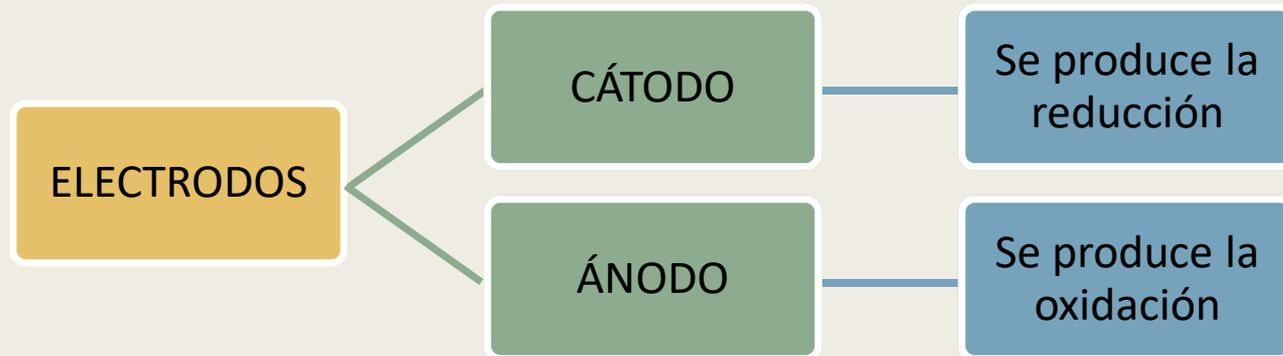
Un electrodo está constituido por una pieza de metal, cuando se encuentra sumergido en una solución que contiene iones del mismo metal, forma parte de una semicelda. Entre los átomos metálicos de electrodo y los iones metálicos en disolución pueden ocurrir dos tipos de interacciones.
