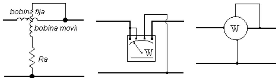
Esquema de conexiones.
