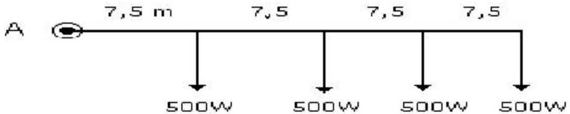
7.- Calcular la caída de tensión en la línea monofásica de 230 v, 50 Hz, de la figura con conductor de aluminio 2x25  $mm^2$  al aire libre con 40 °C de temperatura.
