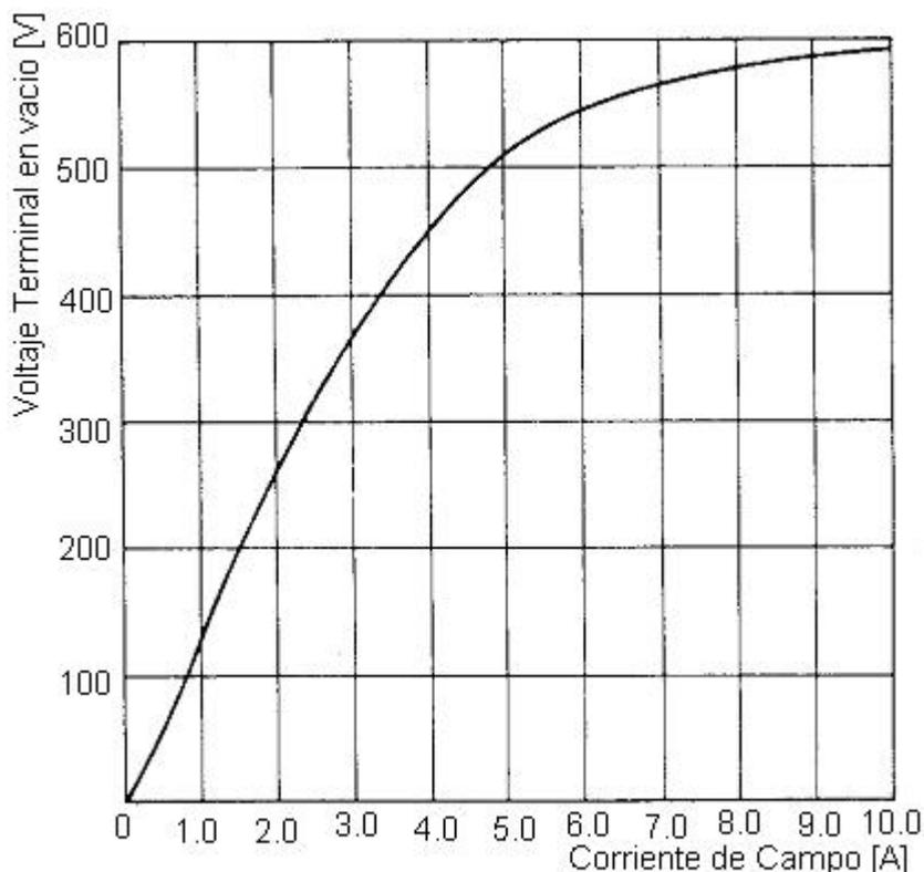
4.- Un alternador trifásico conectado en estrella, tiene una resistencia de inducido despreciable y una reactancia síncrona de  $10 \Omega/\text{fase}$ . Está acoplado a una red de potencia infinita de 11 kV, y se sabe que desarrolla una potencia con factor de potencia 0,673 inductivo, siendo el ángulo de carga de  $10^\circ$ . Calcular: a) la fem de línea producida por el generador; b) La potencia activa que suministra a la red.
