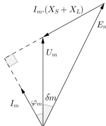
6.-Un motor sincrónico de 208 V, 45 kVA, factor de potencia 0,8 en adelanto, 60 Hz, conexión en  $\Delta$ , tiene una reactancia síncrona de 2,5  $\Omega$ . La resistencia del inducido es despreciable. Sus pérdidas por rozamiento propio y con el aire son de 1,5 kW y sus pérdidas en el núcleo son de 1 kW. Inicialmente, el eje está suministrando una carga de 15 HP y el factor de potencia del motor es 0,8 en adelanto. a) Dibuje el diagrama fasorial de
