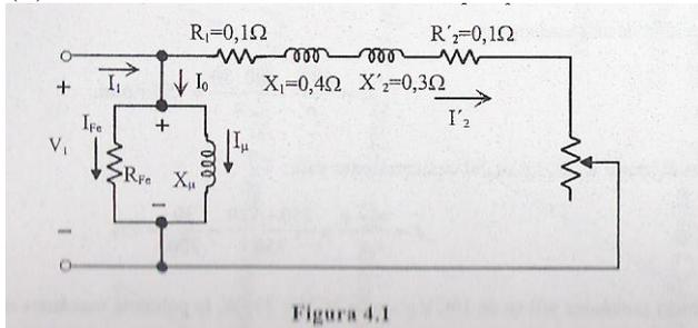
En la figura se muestra el circuito equivalente aproximado del motor reducido al estator o primario, en el que despreciamos la rama en paralelo ya que en el enunciado no se dan datos para poder determinarlos.
