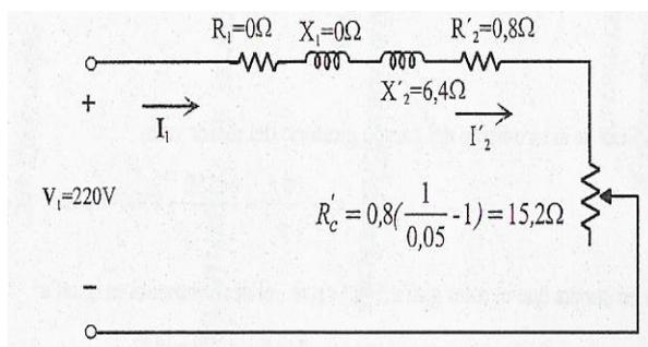
(d) Tomando la tensión simple como referencia, se obtiene una corriente absorbida por fase de:
