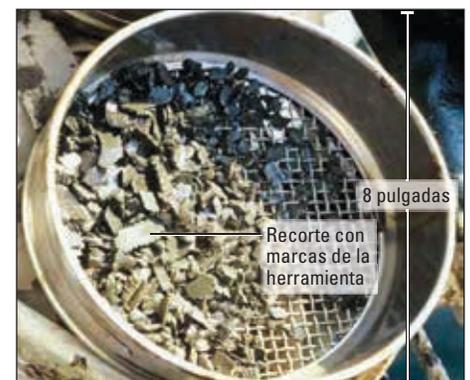
^ Recortes provenientes de una barrena de PDC. La arcilita presente en un tamiz de un analista de registros de lodo muestra las marcas de la herramienta, que constituyen una prueba de la acción de cizalladura de una barrena de PDC.
