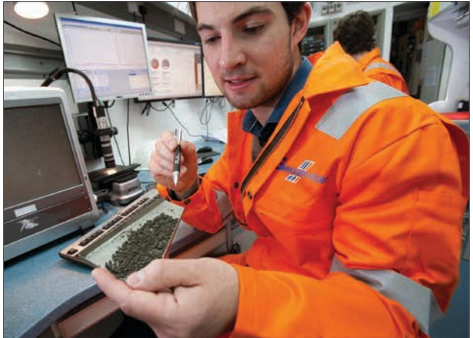
^ Muestra de recortes. Habiendo sido limpiados y secados, estos recortes de lutitas serán examinados con un microscopio.
