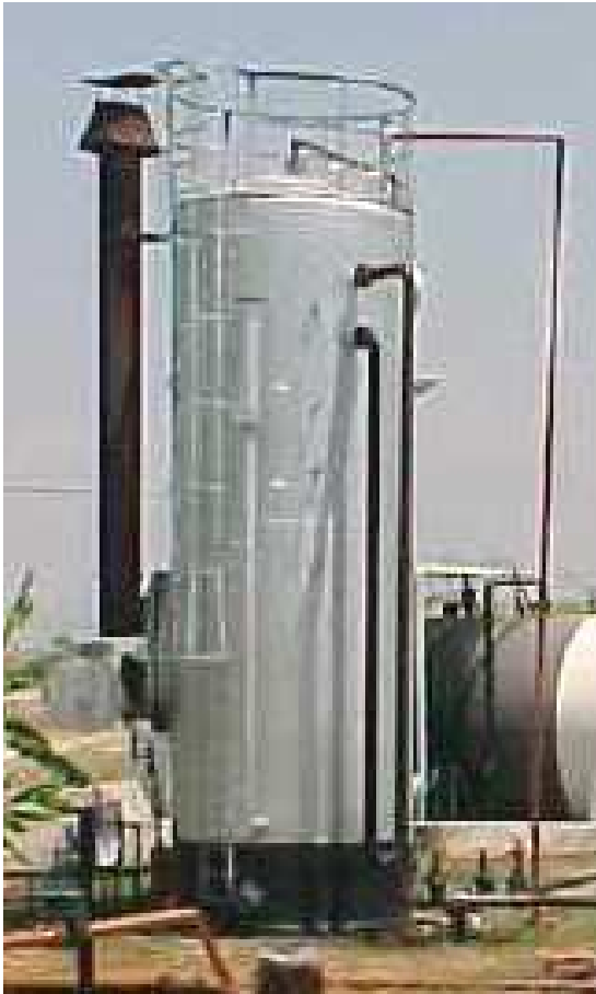
Figura N°19. Foto y Diagrama de un Tratador Térmico.
