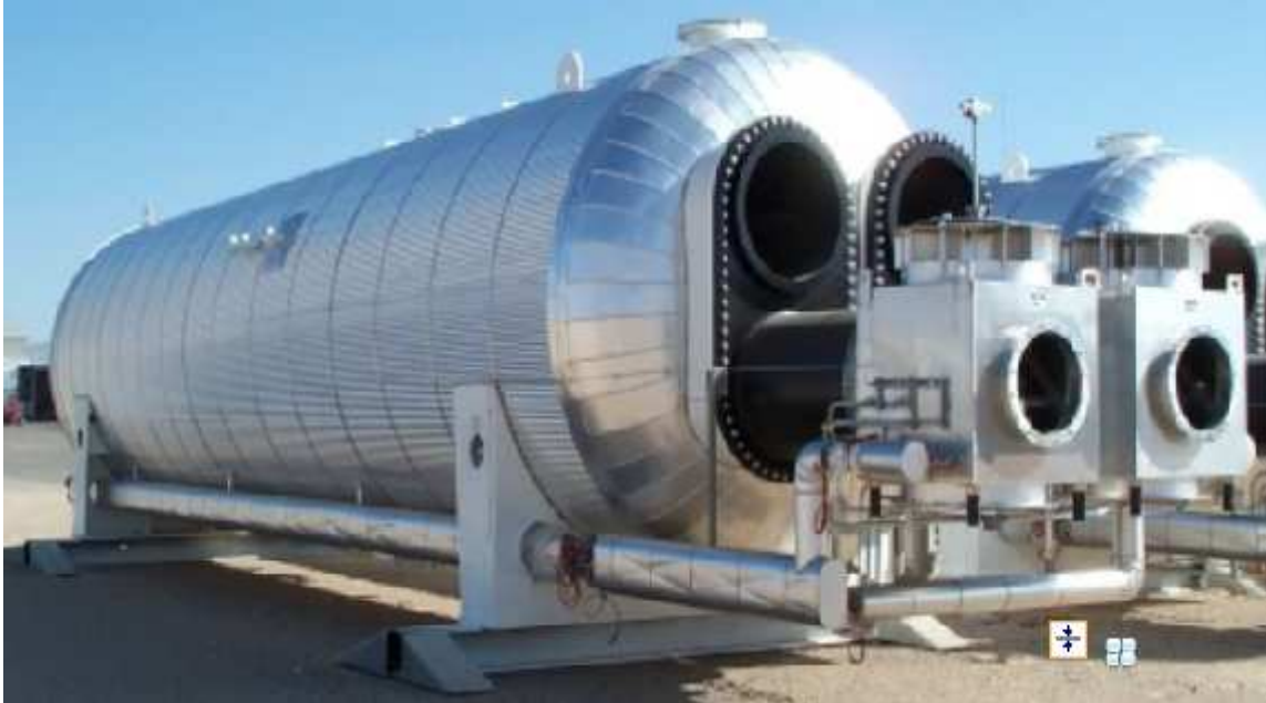
Foto N°6. Un tratador térmico horizontal
