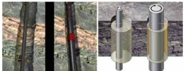
Figura 3. Espacio anular entre columna de perforación y pozo.
