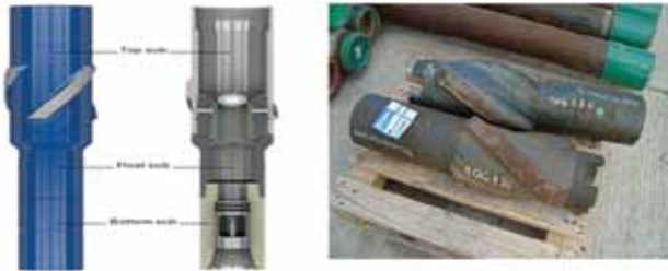
Figura 7. Dispositivo de suelta de trépano y estabilizadores - Proyecto Piloto 2008.
