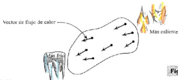
**Figura 4.3.5.** Un campo vectorial que describe la dirección y magnitud del flujo de calor.
