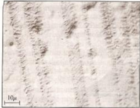
Dominios magnéticos inducidos en un vidrio metálico
