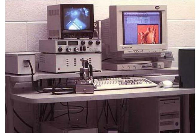
**Microscópio de Fuerza Atomica (AFM) y MFM**, es particularmente útil para ver muestras biológicas.
