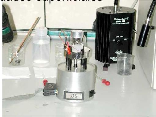
**Microscópio de Barrido de Tunel (STM)** es una técnica microscópica que permite la investigación de superficies conductoras de electricidad abajo de la escala atómica.
