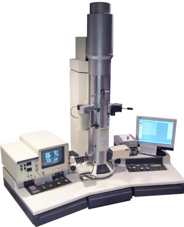
**Microscópio de transmisión electronica (TEM)** estudia átomos y ubicación.
