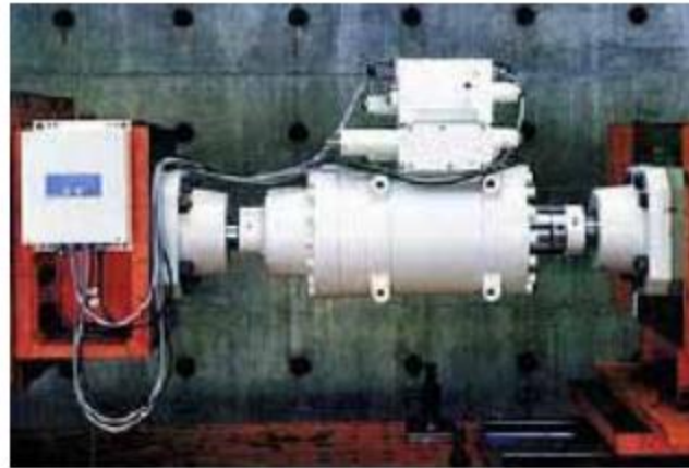
Fig. 7 El Amortiguador HIDAX y Esquema de Instalación en un Piso de un Marco Estructural
