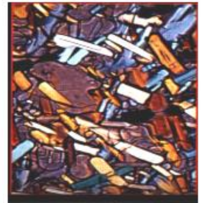
Micrografía óptica de transmisión del nitruro de silicio ( \text{Si}_3\text{N}_4 ). 750X.
