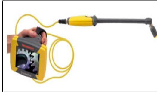
El endoscopio industrial de fibra óptica es flexible y utiliza dos grupos de fibras ópticas, las cuales están protegidas del exterior, cada uno de esos grupos conjunta miles de fibras individuales. Uno sirve de guía o medio transportador de la imagen y el otro ayuda a iluminar el objeto bajo prueba.
