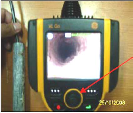
En la siguiente imagen se observa el tubo al cual se le realizará la inspección en el interior, del lado derecho vemos el equipo de inspección visual remota y la sonda que se introducirá al tubo. Es importante mencionar que la sonda con la que cuenta este equipo tiene la ventaja de moverse en todas direcciones. En la parte frontal tiene la cámara y cuenta con un led de iluminación.
