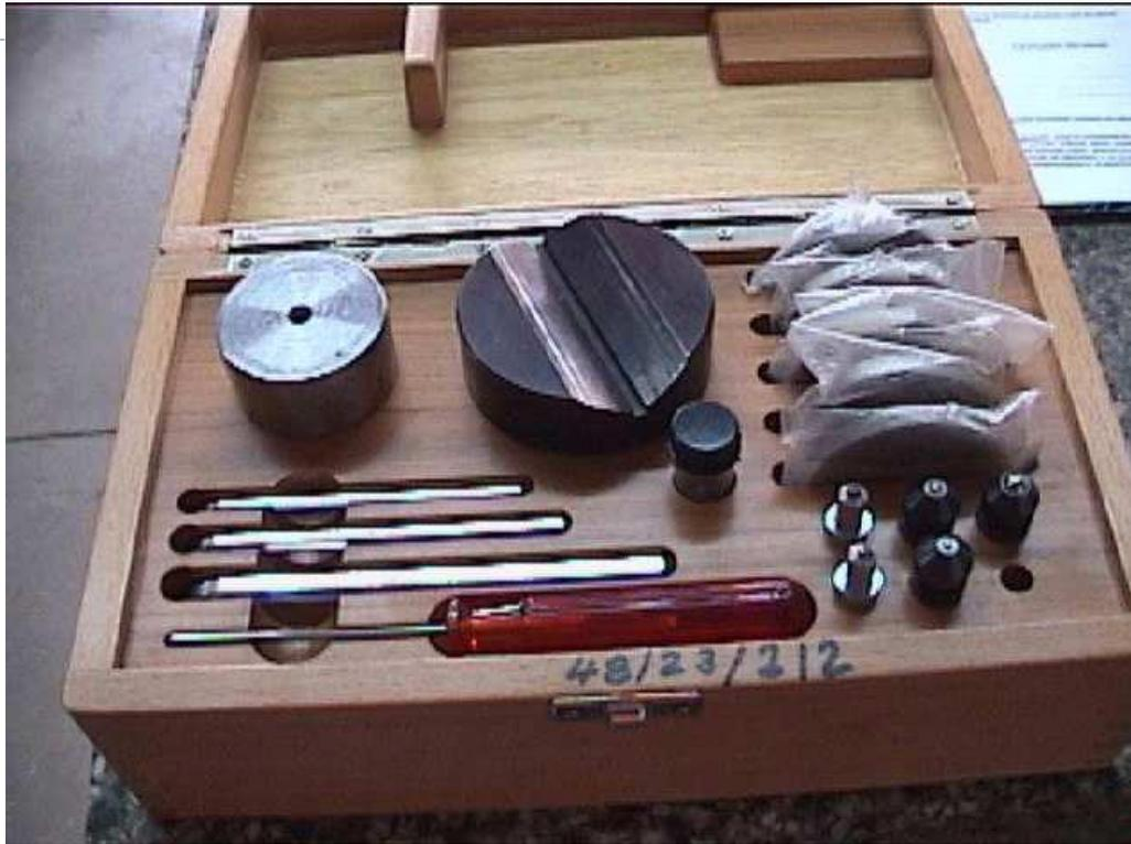
Caja con accesorios para determinación de Dureza:
