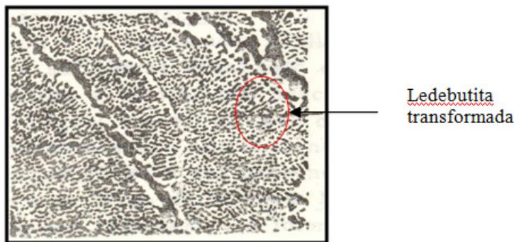
**Fig. 11:** Fundición Blanca Eutéctica. Ataque: nital. Aumento: 500x
