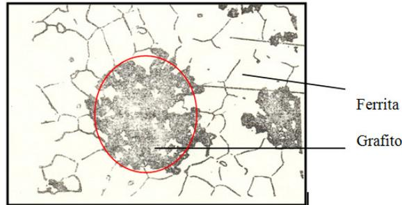
**Fig. 25: Fundición maleable de corazón negro. Ataque: nital. Aumento 500x**
