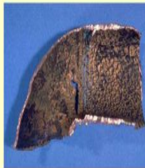
Corrosión en codo de cañería por erosión
