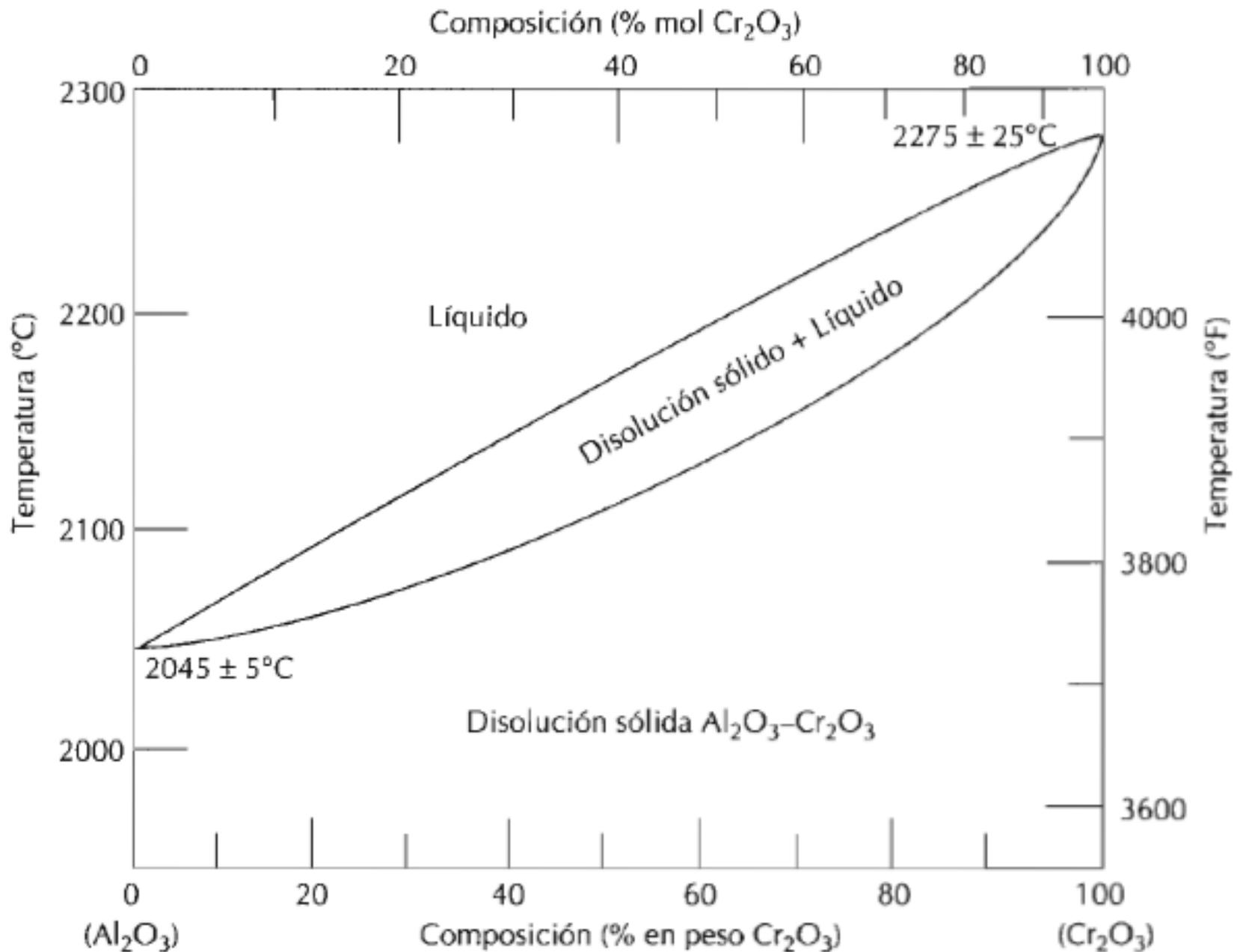
Figura 13.24 Diagrama de fases óxido de aluminio-óxido de cromo. (Adaptado de E. N. Bunting, "Phase Equilibria in the System  $\text{Cr}_2\text{O}_3$ - $\text{Al}_2\text{O}_3$ ", *Bur. Standards J. Research*, **6**, 1931, p. 948.)
