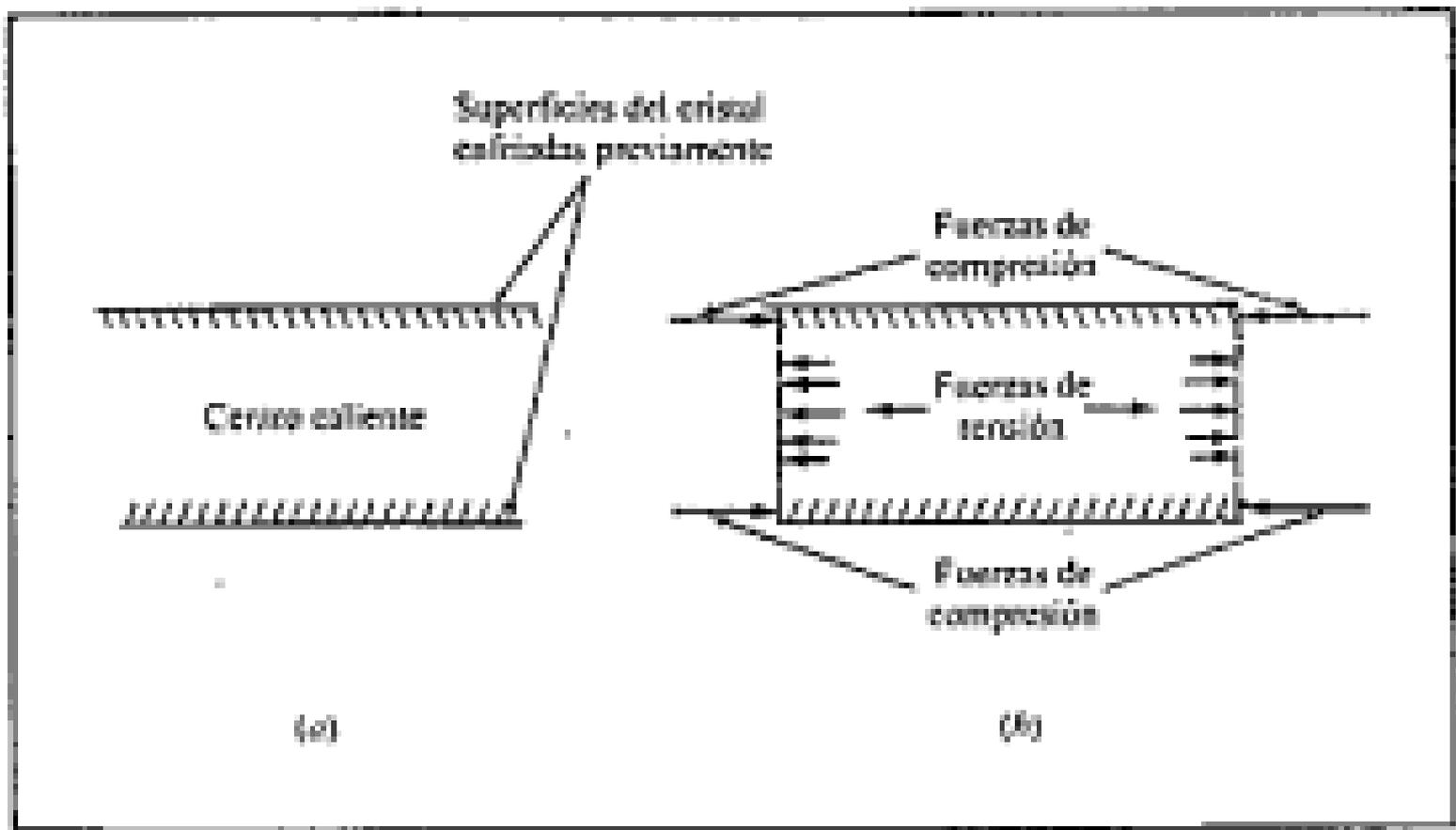
Sección transversal de un vidrio templado. A) después de que la superficie se ha enfriado desde altas  $T$  hasta cerca de la  $T$  de reblandecimiento del vidrio. B) después de que el centro se haya enfriado
