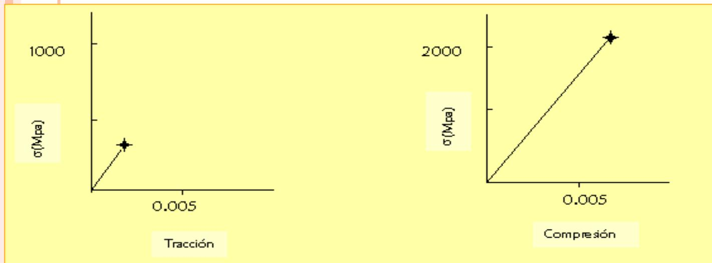
ESTO SE DEBE A QUE LOS PEQUEÑOS DEFECTOS DEL MATERIAL ASÍ COMO LOS POROS INTERNOS ACTÚAN COMO CONCENTRADORES DE TENSIÓN, AMPLIFICANDO SU MAGNITUD. LOS POROS DISMINUYEN EL AREA TRANSVERSAL.
