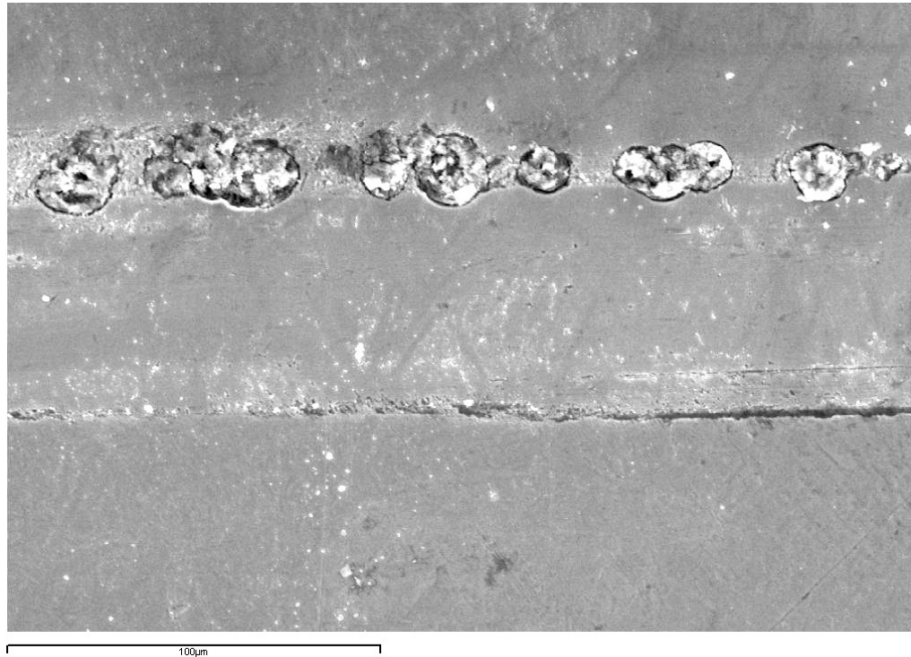
Figura 44: :Picaduras de corrosión localizadas en la raya de la superficie de la aleación 28 tratada (SEM x500)
