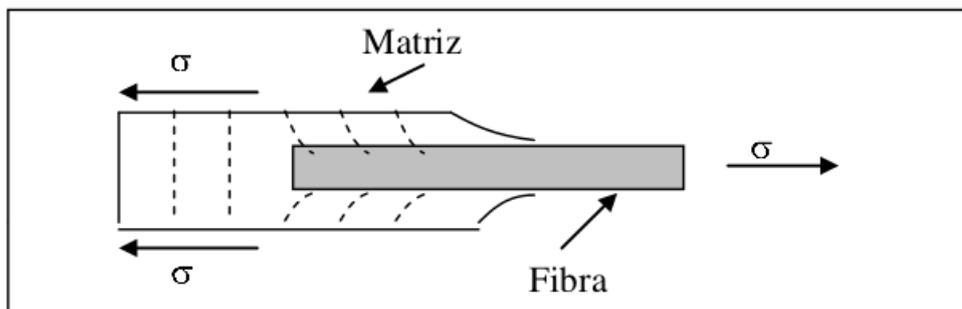
Existe una longitud de fibra crítica para aumentar la resistencia y la rigidez del material compuesto. Esta longitud crítica  $l_c$  depende del diámetro  $d$  de la fibra, de la resistencia a la tracción  $f$  (de la fibra) y de la resistencia de la unión matriz-fibra ( o resistencia a la cizalladura de la matriz)  $c$ , de acuerdo con:
