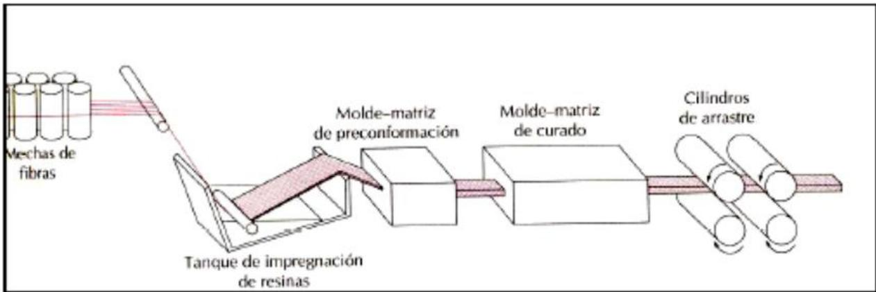
**Figura 9: Diagrama Esquemático del Proceso de Pultrusión**
