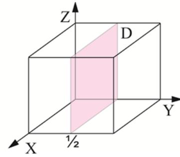
14. La celdilla elemental del Aluminio es cúbica centrada en las caras (FCC). Su masa atómica es 26.97 g/mol y su densidad 2,699 g/cm<sup>3</sup>. Calcular: a) Masa de un átomo. b) Masa de una celdilla unidad. c) Número de celdillas en 1 gr de metal. d) Volumen y arista de la celdilla unidad. e) Radio atómico. f) Factor de empaquetamiento. g) Densidad atómica lineal en las direcciones [1 1 1] y [1 1 0] h) Densidad atómica superficial en los planos (1 1 0) y (1 1 1).
