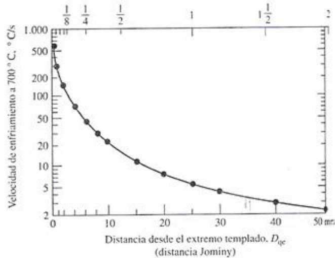
**FIGURA 6.20.** La velocidad de enfriamiento de la barra Jominy (véase la Figura 6.19) varía a lo largo de su longitud. Esta curva es aplicable a casi todos los aceros al carbono y de baja aleación. (De L. H. Van Vleet *Elements of Materials Science and Engineering*, 4th. Ed., Addison-Wesley Publishing Co., Inc., Reading, Mass., 1980.)
