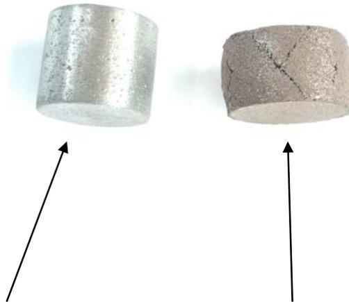
Perfiles y caras: Probeta corta sin ensayar – Probeta corta ensayada (fisuras a 45° aprox.)
