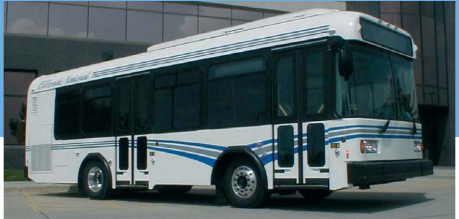
Figura 8.4. Autobús equipado con celdas de combustible poliméricas. En este tipo de aplicaciones se sustituye el motor térmico por una celda de combustible que utiliza hidrógeno gaseoso como energía química primaria para producir electricidad.
