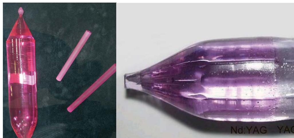
Figura 7.5. Monocristales láser: izquierda, Er:YAG crecido por Czochralski (Cz); derecha, Composite Nd:YAG/YAG, crecido por Cz.
