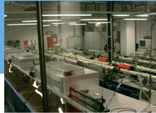
Figura 7.2. Instalaciones láser de alta potencia ( 10^{19}\text{W/cm}^2 ) del Instituto Max Born en Berlín (obsérvese el tamaño del sistema láser en relación a las personas al fondo de la fotografía).
