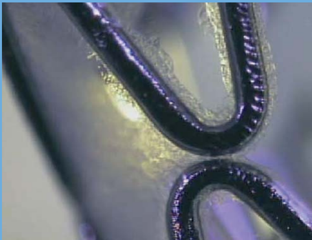
Figura 6.4. Micrografías de nuevos "stents" coronarios recubiertos con polímeros activos de carácter antitrombogénico, y que actúan como sistemas de liberación controlada de fármacos antiproliferativos.
