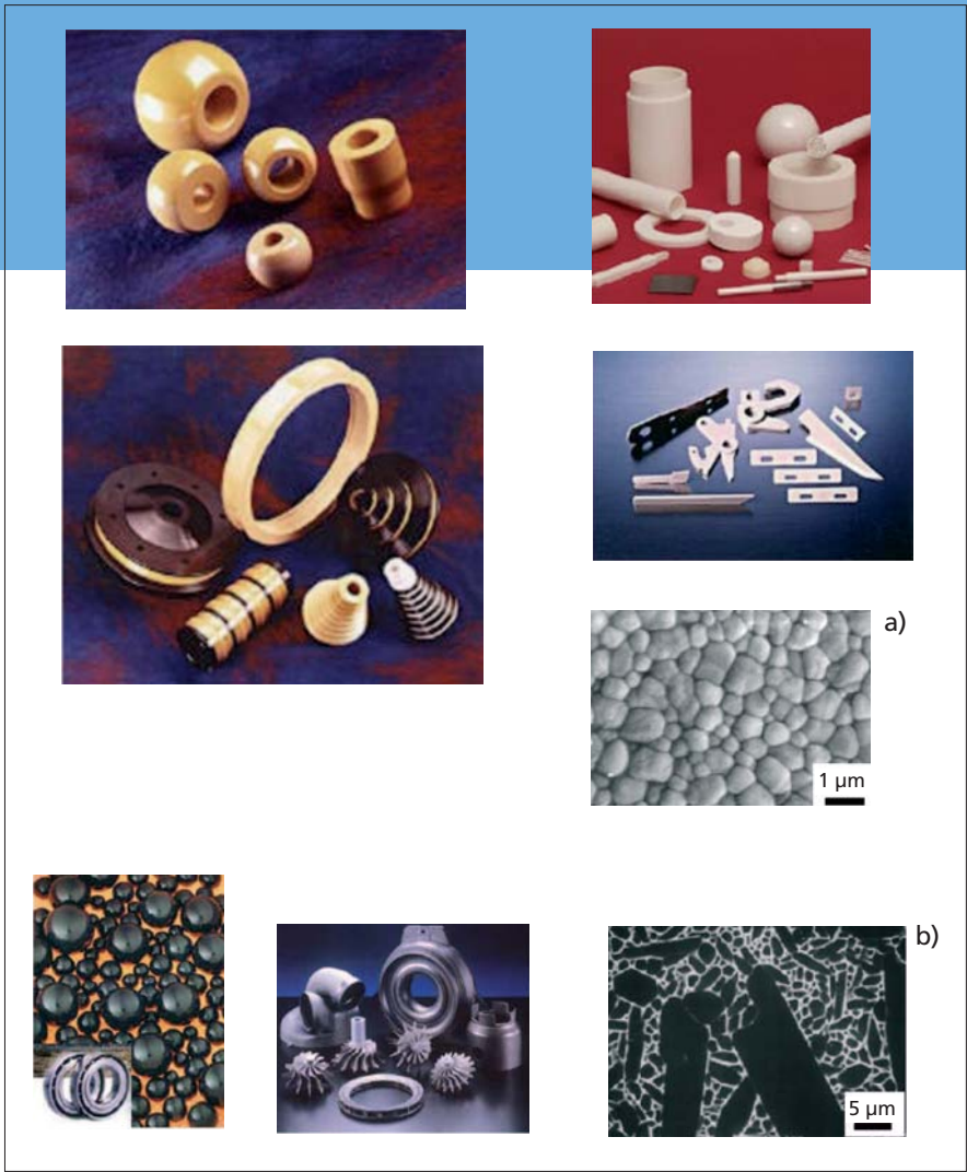
Figura 1.1. Materiales cerámicos tenaces para aplicaciones estructurales de circonia, troqueles, guías, herramientas (superiores) y nitruro de silicio, rodamientos y componentes de motores (inferiores) y sus correspondientes microestructuras [a), b)].
