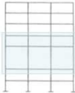
c) Diferencia drástica de altura de columnas.
