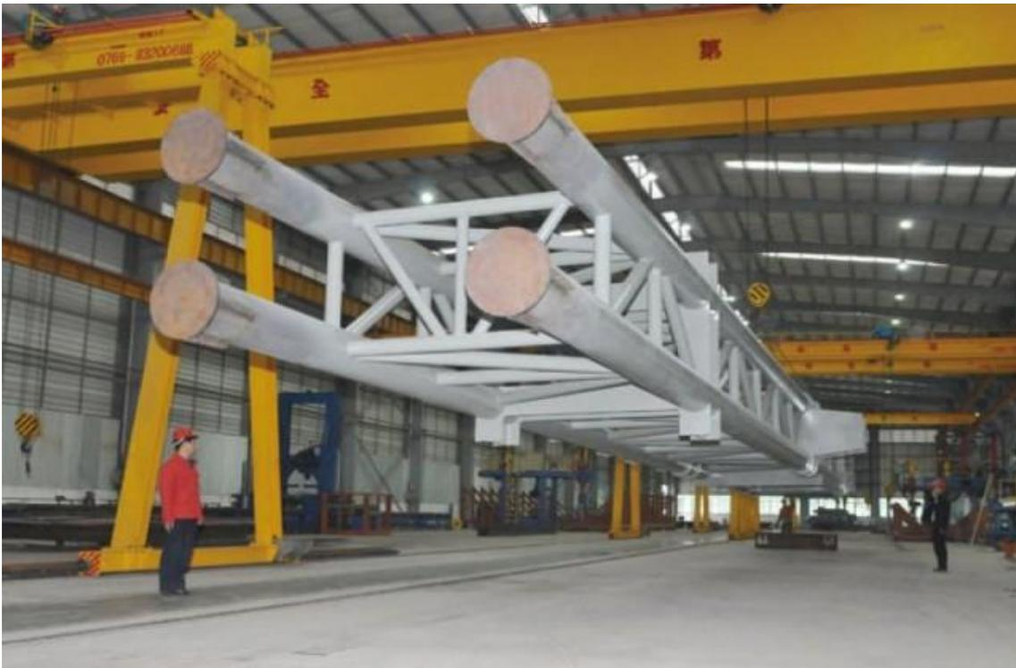
**Figura 3:** Columna armada de acero
