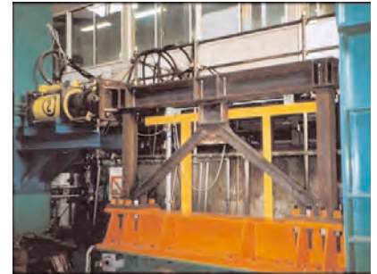
b) Essai d'un contreventement excentré
