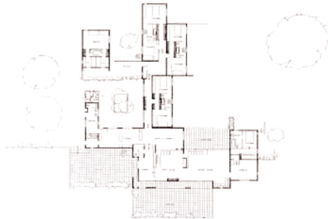
a) Plan comportant de nombreuses saillies et retraits dont les angles rentrants sont le siège de concentration de contraintes en cas de séisme
