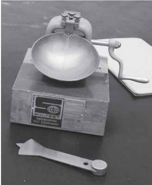
Figura 3.10 Dispositivo de límite líquido y herramienta de ranurado (Cortesía de Braja M. Das, Henderson, Nevada)
