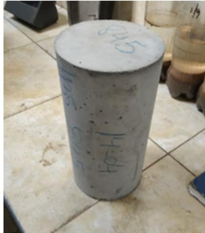
*Probeta de hormigón H-25*
