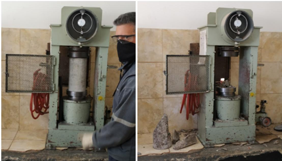
*Máquina de ensayo de probetas a compresión*
