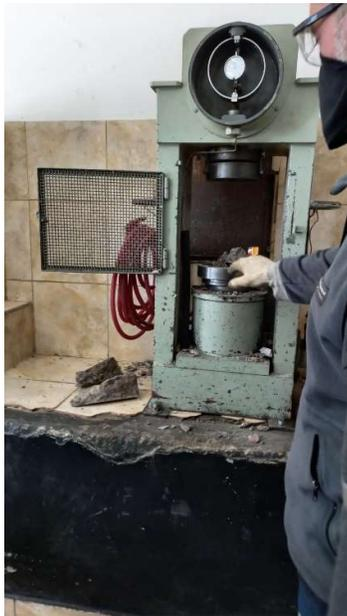
Ensayo de probeta H°
