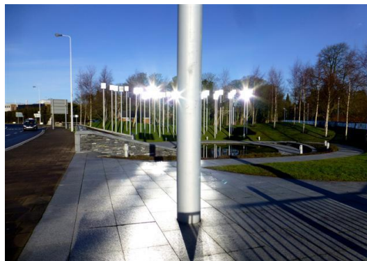
Deslumbramiento mixto: directo (luminarias de fondo), y reflejado (piso con brillo)
