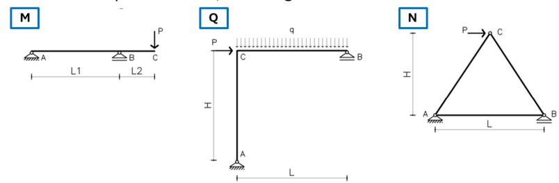
9. Dibuje a mano alzada y sin realizar ningún cálculo, la configuración deformada (elástica) de las siguientes estructuras:
