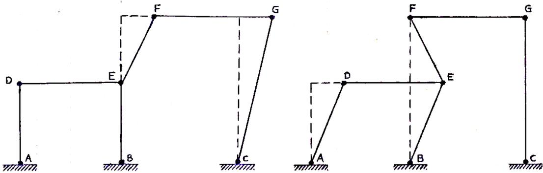
Figura 9: Pórtico de ejemplo. Movimientos de piso independientes.
