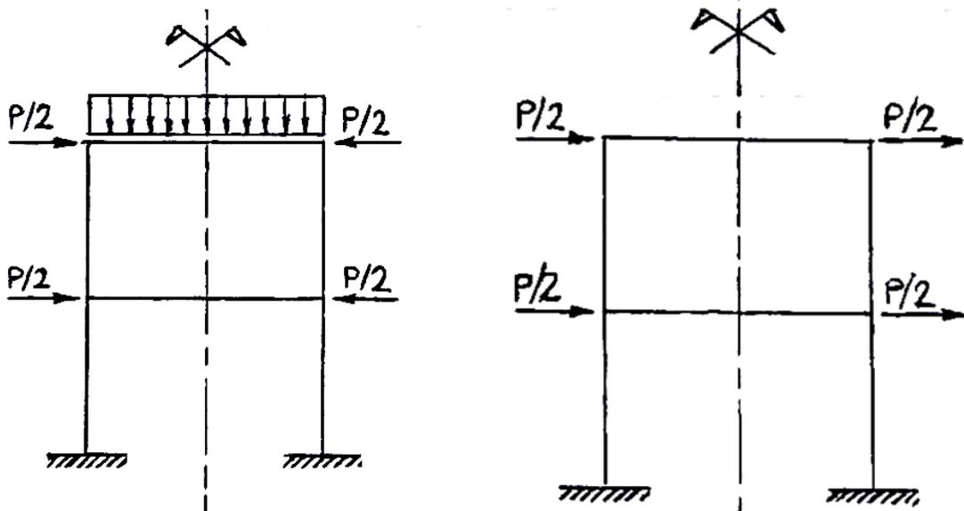
Figura 14: Estados de carga simétrico, a la izquierda y antisimétrico, a la derecha.
