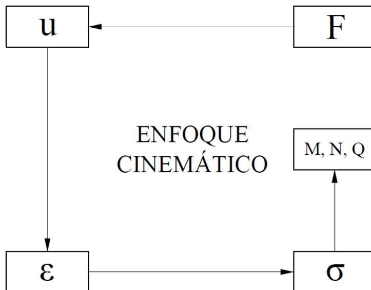
Figura 2: Enfoque cinemático para resolver estructuras según el diagrama de Tonti.
