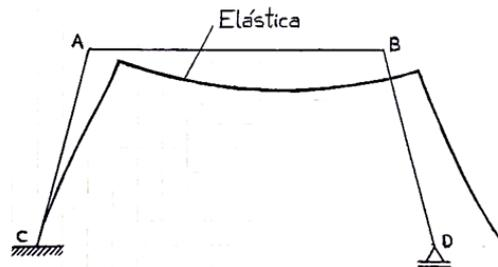
Figura 4: Elástica de deformación del pórtico plano.
