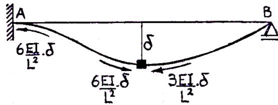
Figura 11: Ejemplo de descenso de apoyo. Datos en la figura superior y esfuerzos en la figura inferior.
