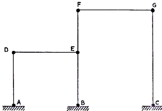
Figura 8: Pórtico de ejemplo. Planteo de una cadena cinemática abierta
