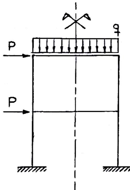
Figura 13: Ejemplo de una estructura con simetría estructural
