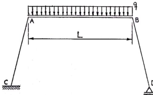
Figura 3: Esquema de un pórtico plano. Estructura con nudos rígidos.
