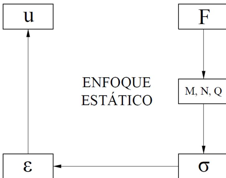
Figura 1: Enfoque estático para resolver estructuras según el diagrama de Tonti.
