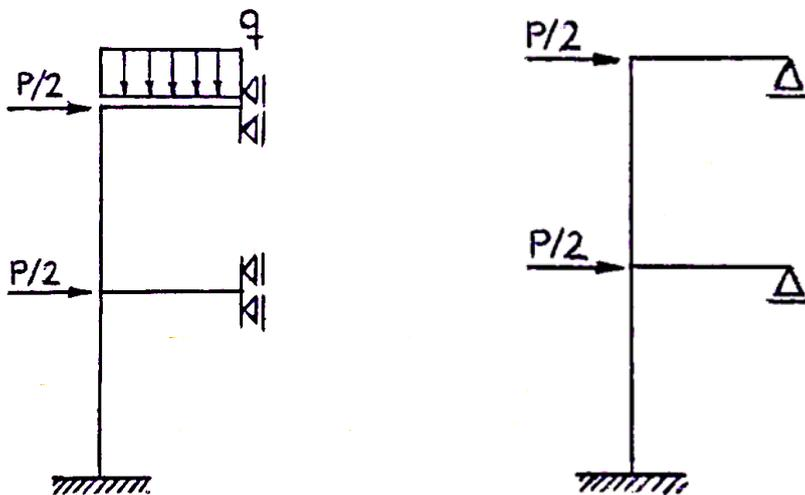
Figura 15: Media estructura, simétrica a la izquierda y antisimétrica a la derecha.
