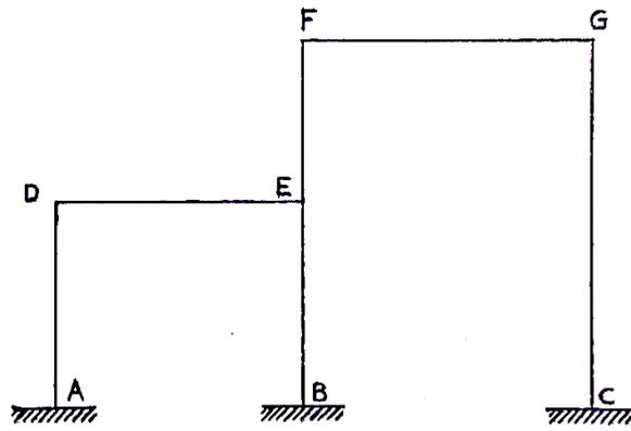
Figura 7: Pórtico de ejemplo. Posee 4 giros nodales y dos movimientos de piso (ver punto 4.B.3.1)
