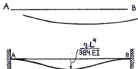
Figura 5: Elásticas de deformación de la viga AB. La elástica superior causada por los movimientos extremos de pieza y la inferior debida a las cargas actuando sobre los nudos indesplazables.
