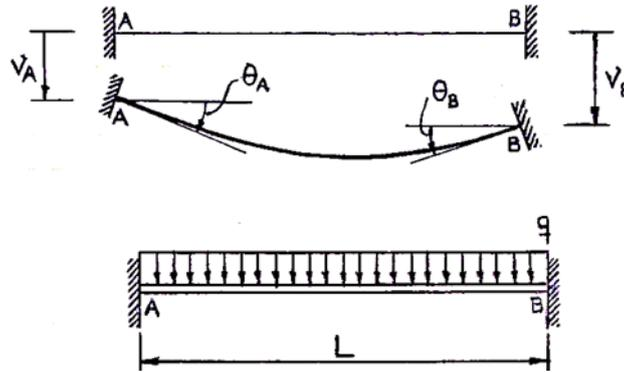
Figura 6: Esquema de cálculo de las elásticas de deformación de la viga AB, debidas a los movimientos extremos de pieza (figura superior) y cargas (figura inferior).
