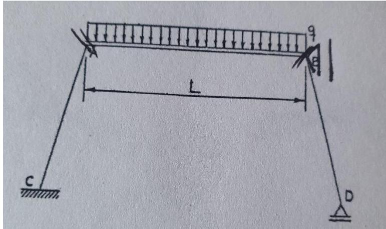
Figura 10: Sistema Fundamental para el pórtico de ejemplo.
