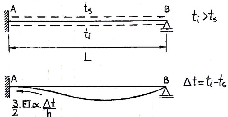
Figura 12: Ejemplo de Acción térmica. Datos en la figura superior y esfuerzos en la figura inferior.
